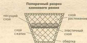
Рис. 2. Структура автомобильного клинового ремня.
